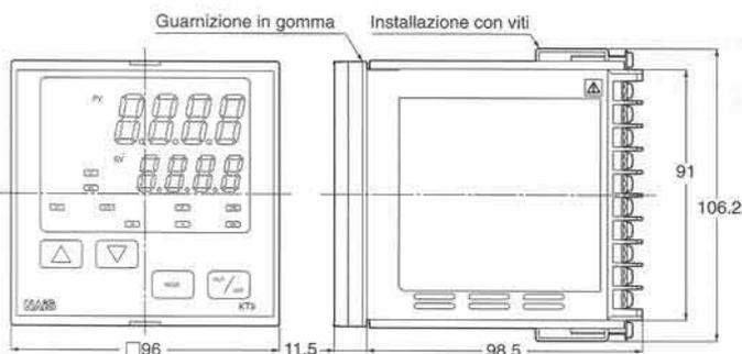
Note: Il terminale di comunicazione è il terminale a vite posizionato sul retro dell'unità.
