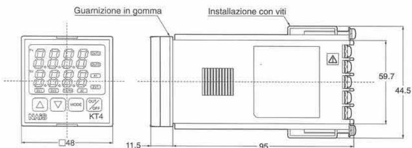
Note: Il terminale di comunicazione è il terminale a vite posizionato sul retro dell'unità.
